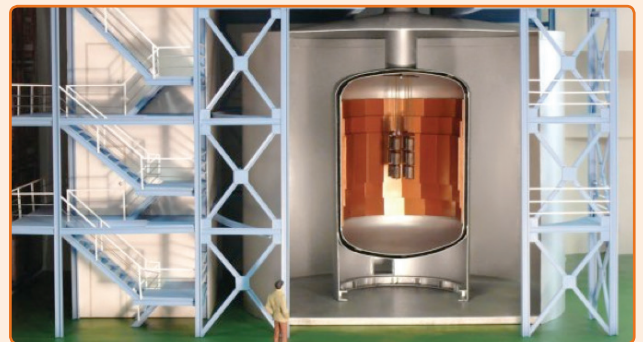
■ Abbildung 2: Das Experiment GERDA (GERmanium Detector Array) am Laboratori Nazionali del Gran Sasso (LNGS) sucht nach dem neutrinolosen Doppel- Beta-Zerfall. Ziel ist die Messung der Neutrinomasse und die Beantwortung der Frage, ob das Neutrino sein eigenes Antiteilchen ist.
